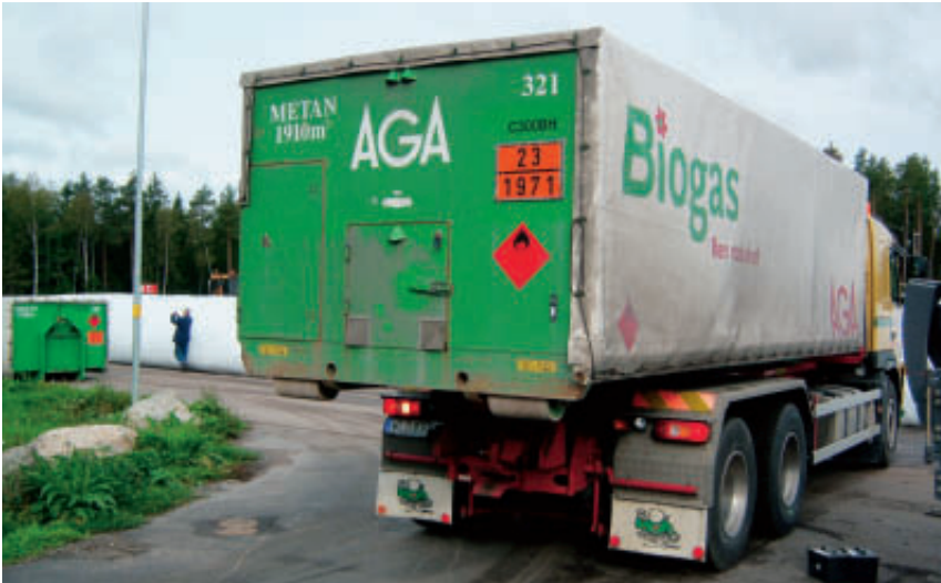
Abb. 9: Straßentransport von Biomethan in Schweden mit einem „Swap-body-system“
